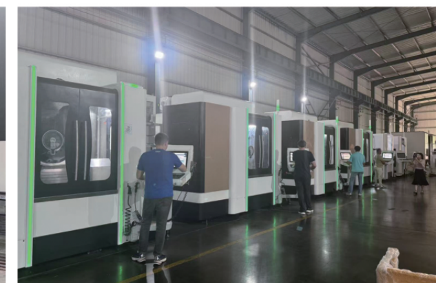
五轴叶片铣削加工中心 Five axis blade Milling Machining Center
