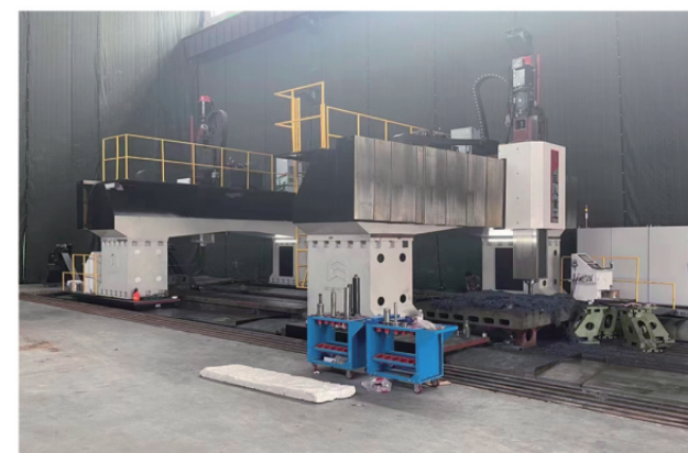
24米双龙门镗铣加工中心 4300x24000 Double Column machining center
